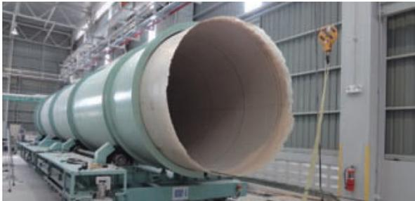
Machine à mouler cylindrique
